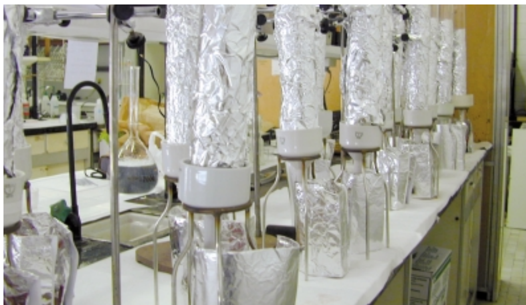
Columnas de lixiviación para ensayos con fertilizantes
