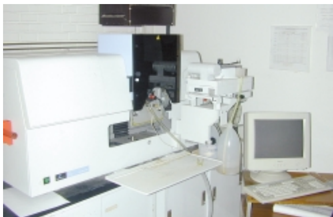
Aparato de absorción atómica para análisis de macro y micronutrientes metálicos
